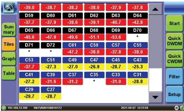
パワーメータには、現在のチャンネルとそのチャンネルのピークの波長が表示されます。パワーメータにより監視されたチャンネルの複合電力の最高値と最低値から電力レベルの平均が計算され、結果の値は中央に表示されます。
